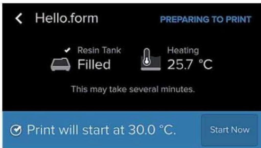
开始打印之前，树脂槽将会添加树脂并加热至 31° C 左右。树脂填充到树脂槽合适的打印容量位置（树脂槽上黑色刻线）后，打印机即可开始自动打印。
