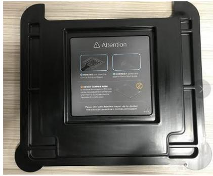
**注意：** 在连接电源之前，一定要去除所有包装材料。（打开上盖，取出打印机内的保护盖板）
